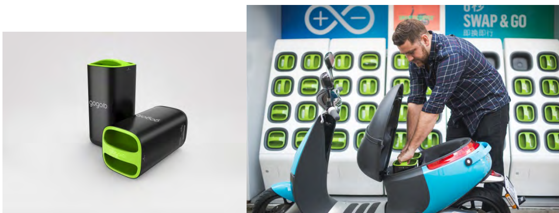
▲「Smartscooter」のバッテリー。充電の面倒や手間を省き、バッテリーご市内随所の24時間ステーションでフル充電のバッテリーと交換可能なシステムが画期的 © 2014-2016 Gogoro Inc.
